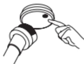
Na de installatie en na een lange afwezigheid moet u de juiste werking van de rookdetector(s) testen met de testknop.
