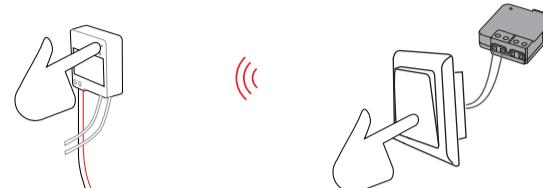
Le module récepteur a une mémoire de 6 programmations. L'émetteur peut contrôler soit 2 récepteurs indépendants, soit 2 combinaisons de récepteurs.
