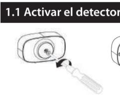
Abra la parte trasera del detector con un destornillador de cruz y retire la lengüeta a nivel de la pila.
