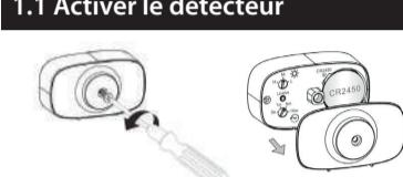
Ouvrir l'arrière du détecteur avec un tournevis en croix et retirer la languette au niveau de la pile.
