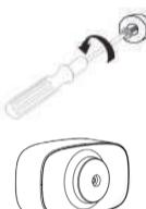
Fije el soporte magnético a la pared con el tornillo que viene incluido en un lugar de paso que permita que se accione el detector.
