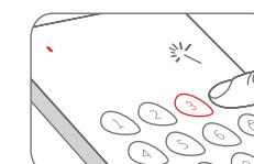
Si no se realiza ninguna operación en el modo de configuración durante un periodo de 10 segundos, el teclado saldrá automáticamente del modo de configuración. También puede pulsar [#] para salir.
