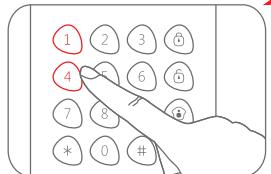
Si un bip retentit et l'indicateur lumineux reste allumé pendant 10 secondes, alors le réglage est réussi.
