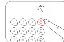
Als er een inbraak is, dan wordt het alarmsysteem geactiveerd. De sirene zal een geluidssignaal geven, het bedieningspaneel verzendt een SMS en belt automatisch naar de opgeslagen telefoonnummers om de gebruikers te waarschuwen. (De SMS-melding is alleen van toepassing voor GSM-alarmsystemen.)
