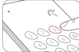
Als er tijdens de installatiemodus binnen 10 seconden geen bediening is, zal het toetsenbord de installatiemodus automatisch verlaten. U kunt ook op [#] drukken om te stoppen.
