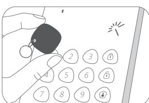
Om de verbinding met RFID-tags te wissen, voer [administratiecode] + [#] in om het toetsenbord uit de slaapstand te halen en druk vervolgens 6 seconden op [9]. RFID-tags worden gewist na één pieptoon.
