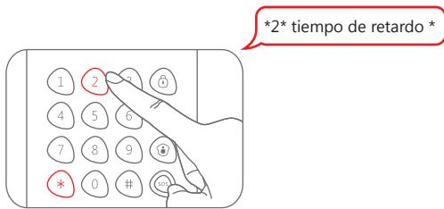
Si suena un pitido y el indicador LED se mantiene encendido durante 10 segundos, significa que la configuración se ha realizado correctamente.
