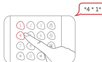
Si suena un pitido y el indicador LED se mantiene encendido durante 10 segundos, significa que la configuración se ha realizado correctamente. **Nota:** Configuración predeterminada: 1, encender el tono del teclado.
