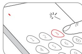
En mode réglage, si il n'y a aucune action dans les 10 secondes, le clavier quittera l'état de réglage automatiquement. Vous pouvez également appuyer sur [#] pour quitter.
