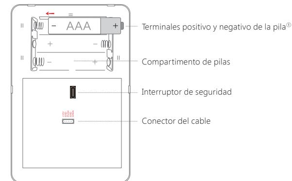
① El teclado emitirá dos pitidos cada dos segundos y el indicador LED parpadeará una vez si el nivel de batería es bajo.
