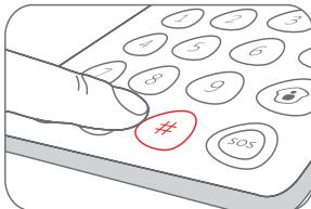
2. Appuyez sur [9], un bip retentit et l'indicateur lumineux s'allume. Le clavier passe en attente de connexion.
