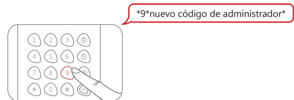
Si suena un pitido y el indicador LED se mantiene encendido durante 10 segundos, significa que la configuración se ha realizado correctamente.
