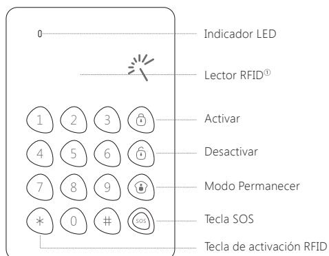
① La tarjeta/etiqueta RFID (125 KHz) se puede comprar por separado. Máximo soportado 50 unidades.
