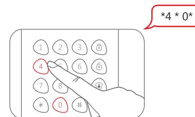
Wanneer een pieptoon te horen is en de LED-indicator blijft gedurende 10 seconden aan, dan is de installatie geslaagd.
