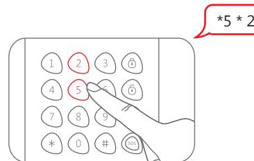
Si suena un pitido y el indicador LED se mantiene encendido durante 10 segundos, significa que la configuración se ha realizado correctamente.
