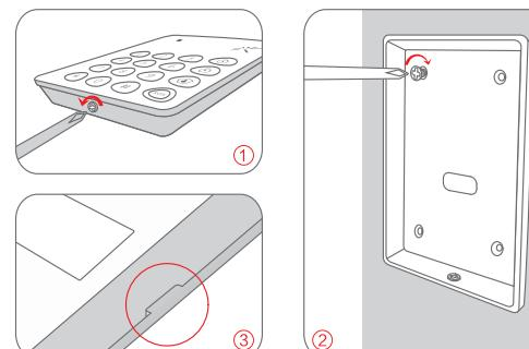
**Nota:** Si se abre la tapa trasera del teclado, se disparará el interruptor de seguridad. Desactive la alarma siguiendo las instrucciones de la página 22-23.
