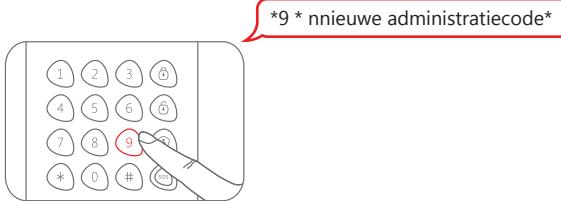
Wanneer een pieptoon te horen is en de LED-indicator blijft gedurende 10 seconden aan, dan is de installatie geslaagd.
