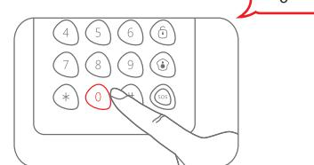
Wanneer een pieptoon te horen is en de LED-indicator blijft gedurende 10 seconden aan, dan is de installatie geslaagd.
