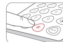
2. Pulse [3] para entrar en el modo de configuración. El indicador LED se encenderá.
