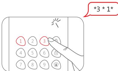
Quando é ouvido um toque e o indicador luminoso fica aceso durante 10 segundos, isso significa que a configuração foi bem-sucedida. Depois de configurar, introduza o código de utilizador ou o código de administrador e a tecla [#], e, de seguida, prima sem soltar a tecla [SOS] durante 3 segundos para fazer uma chamada de emergência.
