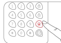
Cuando el panel de alarma reciba la señal, la sirena emitirá un pitido y el indicador [Modo Permanecer] se iluminará. El sistema de alarma se activará.
