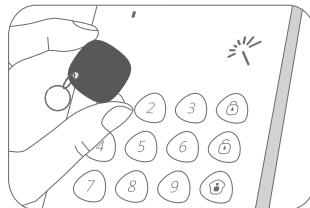
Pour annuler la connexion des balises RFID, saisissez [code admin] + [#] pour réactiver le clavier puis maintenez enfoncé [9] pendant six secondes. Les balises RFID sont toutes effacées après l'émission d'un bip.
