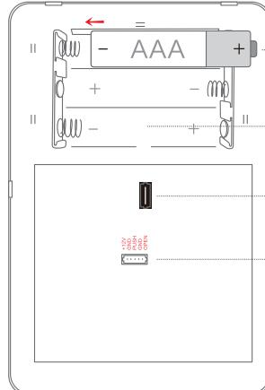
Positieve en negatieve contacten voor de batterij<sup>①</sup>
