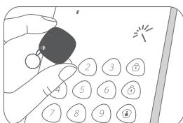
Para desconectar las etiquetas RFID, introduzca [código de administrador] + [#] para activar el teclado y a continuación, mantenga pulsado [9] durante seis segundos. Sonará un pitido para indicar que se han eliminado todas las etiquetas RFID.
