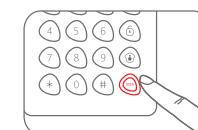
Als het invoeren van een code vóór SOS wel is ingesteld, dient de gebruiker eerst de gebruikerscode of administratiecode in te voeren, voordat hij de [SOS]-toets 3 seconden ingedrukt houdt om een noodoproep te sturen.
