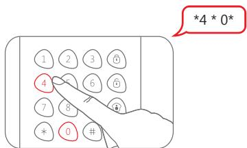
Si suena un pitido y el indicador LED se mantiene encendido durante 10 segundos, significa que la configuración se ha realizado correctamente.
