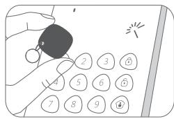
Para eliminar a ligação das etiquetas RFID, introduza o [código de administrador] + [#] para activar o teclado e, em seguida, prima [9] durante seis segundos. Todas as etiquetas RFID são eliminadas depois de ouvir um toque.
