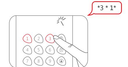
Si suena un pitido y el indicador LED se mantiene encendido durante 10 segundos, significa que la configuración se ha realizado correctamente. Después de realizar la configuración, debe introducir el código de usuario o el código de administrador y pulsar la tecla [#]. A continuación, mantenga pulsada la tecla [SOS] durante 3 segundos para enviar la llamada de emergencia.
