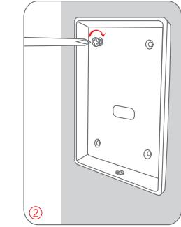
**Remarque :** L'ouverture du couvercle arrière du clavier actionnera le contact anti-sabotage, désactivez l'alarme en suivant les instructions de désarmement à la page 22-23.
