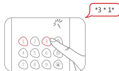
Wanneer een pieptoon te horen is en de LED-indicator blijft gedurende 10 seconden aan, dan is de installatie geslaagd. Na het instellen dient u de gebruikerscode of administratiecode in te voeren en de [#]-toets. Houd vervolgens de [SOS]-toets 3 seconden ingedrukt om een noodoproep te sturen.
