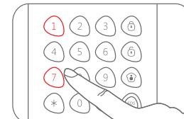
Wanneer een pieptoon te horen is en de LED-indicator blijft gedurende 10 seconden aan, dan is de installatie geslaagd.
