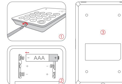
**Remarque :** Si vous ouvrez le couvercle arrière du clavier, le contact anti-sabotage se déclenchera, désactivez l'alarme en suivant les instructions de désarmement à la page 22-23.
