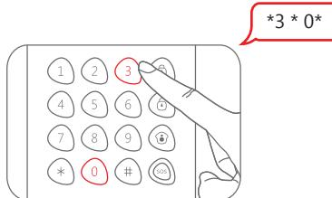
Si un bip retentit et l'indicateur lumineux reste allumé pendant 10 secondes, alors le réglage est réussi.
