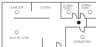
Figura 1: Lugares donde colocar detectores de humo en residencias unifamiliares con una zona de dormitorios.
