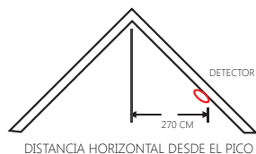
Figura 5: Lugares recomendados para instalar los detectores de humo en habitaciones con techos inclinados, a dos aguas o altos.
