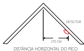
Figura 4: Locais ideais e aceitáveis recomendados para montar detectores de fumo.
